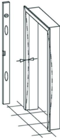
Der **Verzug**, also die Durchbiegung von der Bezugsgeraden auf der Anschlagseite der Zarge, darf 2,5 mm bei Zargen mit Wanddicken >125 mm nicht überschreiten. Kleinere Wanddicken haben nur geringe Biegefestigkeiten und können daher bei der Montage ausgerichtet werden.
