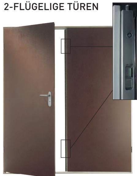
2-flügelige Türen sind nur als einbaufertige Türelemente lieferbar. Sie bestehen aus einem Gangflügel mit BB/PZ-Schloss, einem Standflügel mit Alu-Anschlagprofil und verdeckt liegenden Kantenriegeln. Im Gang- und Standflügel können auf Wunsch Lichtöffnungen eingebaut werden.
