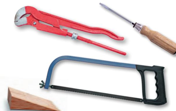
entsprechende Schläge mit der Hand zu simulieren. Es dürfen aber auch noch weitere Werkzeuge verwendet werden: Schraubendreher, Rohrzange, Verlängerungsstahlrohr, verschiedene Kunststoff-/Holzkeile sowie diverse Sägen (Holz-, Blatt- und Bügelsäge).
