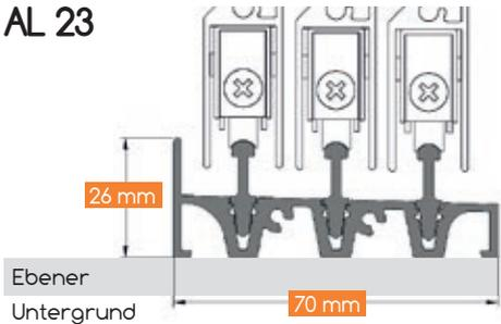
Separate Führungsleisten für das Bodenprofil der AL23 ermöglichen eine exakte Aufnahme der Schiebeelemente, wodurch sich weder Schmutz noch andere Partikel auf den Rollenlauf setzen können. Die konstruktive Schräge gewährleistet zudem den Wasserablauf von der Führungsschiene.
