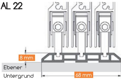
Durch die spezielle Rollenaufnahme der Schiebeelemente hat die AL22 am Boden eine extra flache Führungsschiene für eine nahezu ebene Übergangsschwelle.
