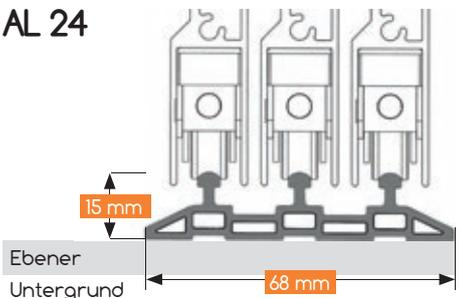
Die untere Führungsschiene der AL24 mit integrierten Stegen verspricht einen leichtgängigen Rollenlauf der Glaselemente und stabilisiert das Profil zusätzlich.
