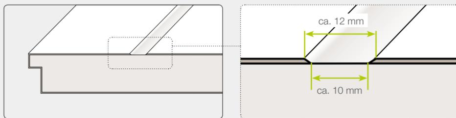
Die Lines Art Fräsung im Detail.
