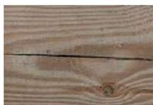
Spannungsrisse durch die Holzrocknung
