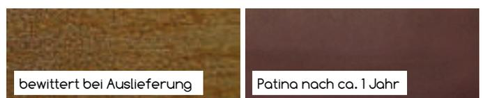
Im Bewitterungsprozess können sich kleine Rostpartikel auf der Oberfläche des Sichtschutzes oder auf dem Boden absetzen. Diese sollten zeitnah entfernt werden.
