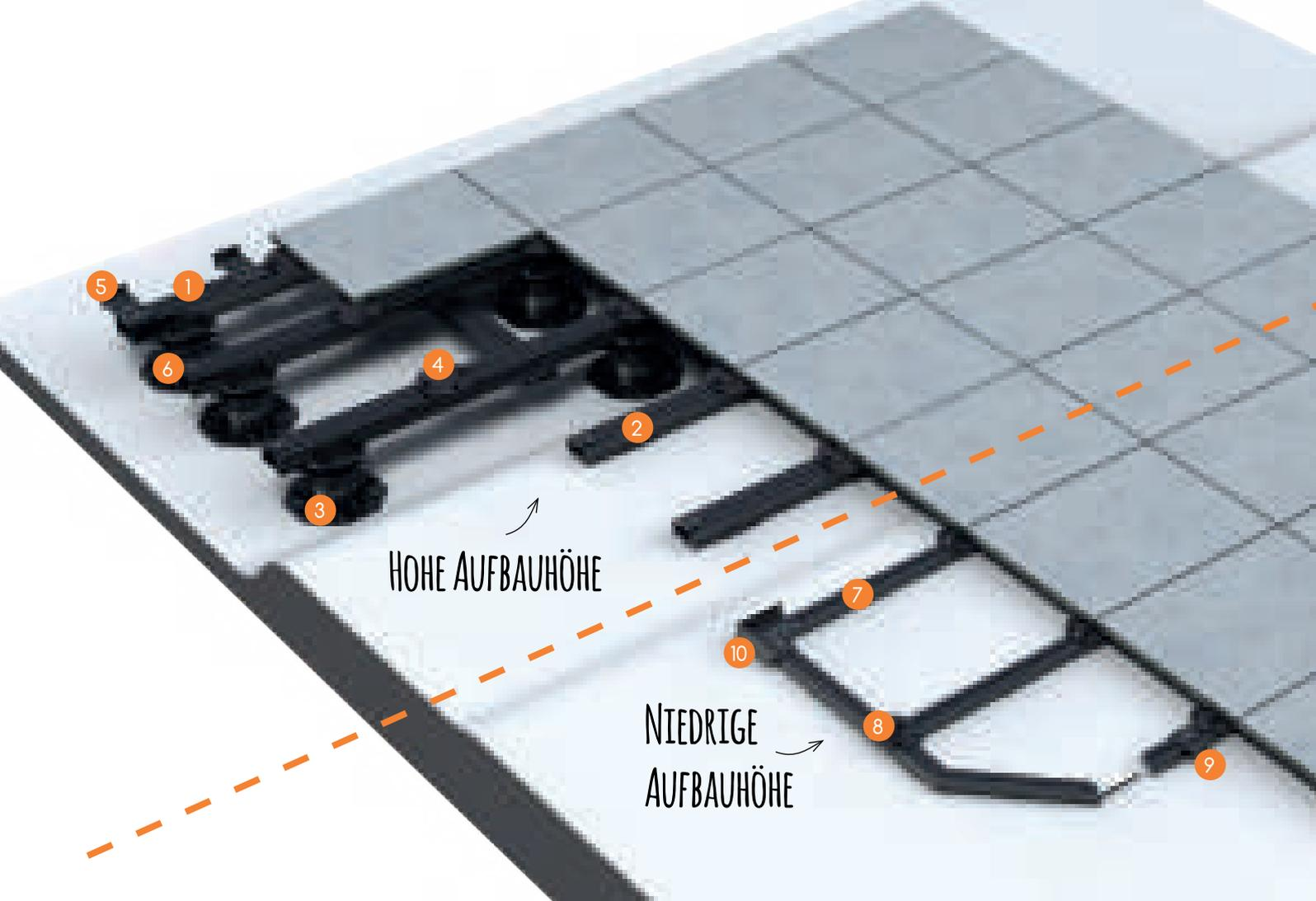
Verlegung von Terrassenplatten bei hoher Aufbauhöhe:
