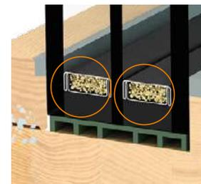
Der Wärmeschutz eines Fensters entscheidet, wie viel Wärmeenergie nach außen dringt. So bemisst der U-Wert den Wärmedurchgangskoeffizienten: Je kleiner, desto besser gedämmt. Alte Verbundfenster haben einen  $U_w$ -Wert von ca. 3,0. Zum Vergleich: Die ENERGYLINE PLUS von Gaulhofer kommt auf passivhaustaugliche 0,59! Die Gaulhofer-Thermostop®-Technologie sorgt durch hochwärmedämmende Glasabstandhalter zusätzlich, dass Kondensation entgegen gewirkt wird.
