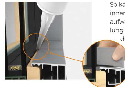
So kann keine Feuchtigkeit von außen oder innen in die Fensterkonstruktion eindringen: Die aufwändig von Hand eingepresste Nassversiegelung aus UV-beständigem Spezial-Silikon dichtet den Glasanschluss von Gaulhofer-Holz-Alu-Fenstern hermetisch sowie dauerhaft ab.
