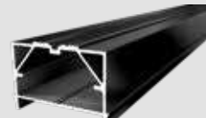
BIG-Isostep (Alu) 54 Terrassenlager Abstand Auflage- punkte max. 110 cm
